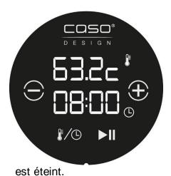
Réglage de la température par paliers de 0,5 °C (25 – 90°C) ou 1 °F 77 – 194 °F).
